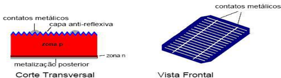
Figure 9. Apresenta com detalhes o corte transversal e uma vista frontal de uma célula fotovoltaica
