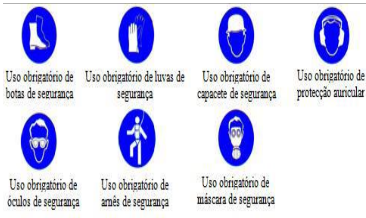
Figura 1: sinalização de segurança obrigatório
