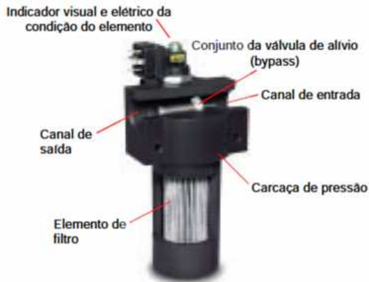
Figura 6. Filtro com indicador visual da condição do elemento.
