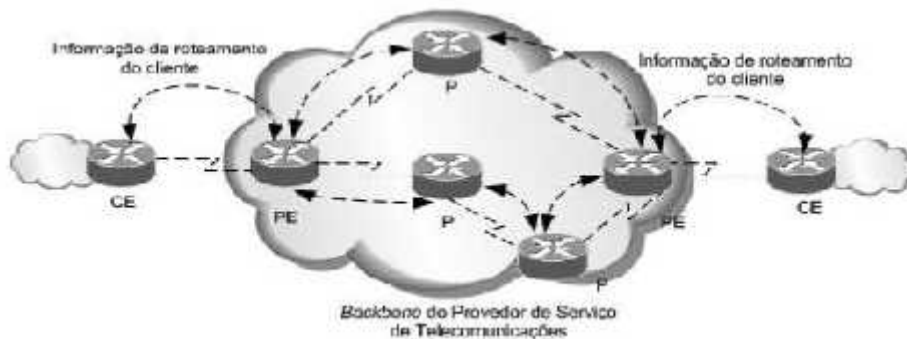
Figura 6 – Modelo Ponto-a-Ponto. Fonte: (Oliveira et al. 2012)
