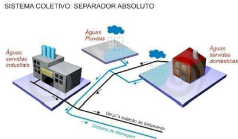
Figura 3: Sistema de esgotamento separador absoluto. Fonte: Dias (2009)
