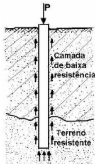
Figura 5 - Mecanismo de resistência da fundação profunda
