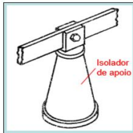
Figura 10: Isolador típico de apoio de um PT
