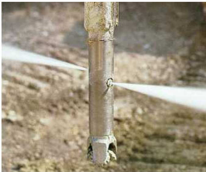
Figura 17 - bico de injeção para jet grouting [pinto,a].
