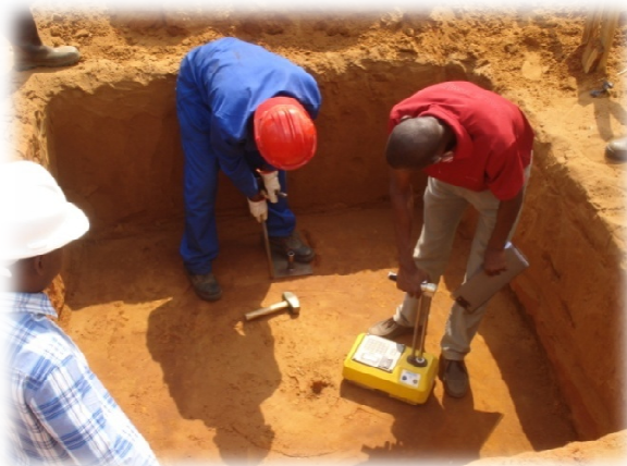
Fig.28-Ensaio de compactação "troxler"
