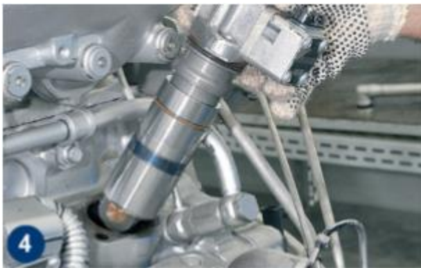
Figura 21: Unidade injetora (bomba).
