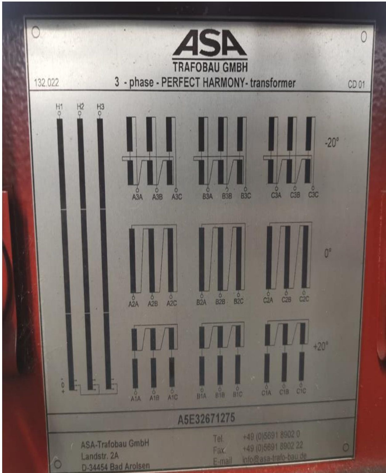
ESQUEMA DE LIGAÇÃO DA CONFIGURAÇÃO DOS ENROLAMENTOS DO TRANSFORMADOR DO VSD PH
