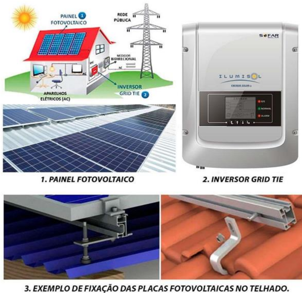
Figura 3: Materiais necessários para instalação da energia solar fotovoltaica
