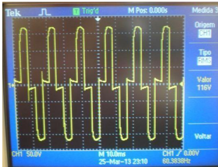
Figura 18: Forma de onda na saída do no-break
