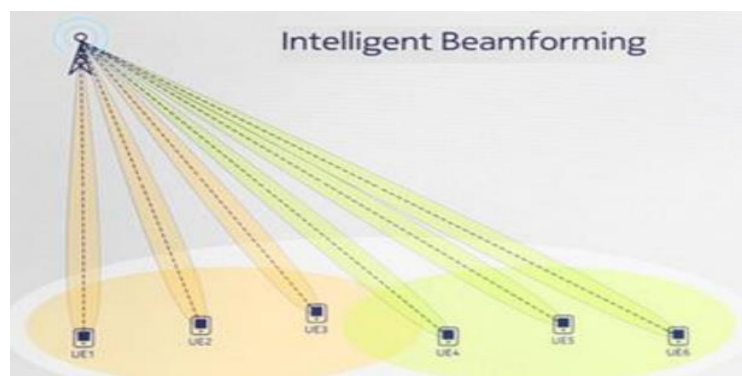
Figura 12: Antenas inteligentes de uma rede 5G distribuindo sinal beamforming
