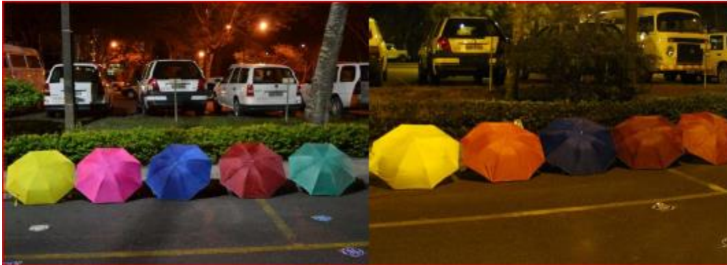
Figura 3. Comparativo entre duas fontes luminosas com diferentes IRC's
