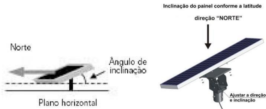
Figura 15. Deve estar voltado para o Norte Geográfico. Fonte: SunLab (2018)
