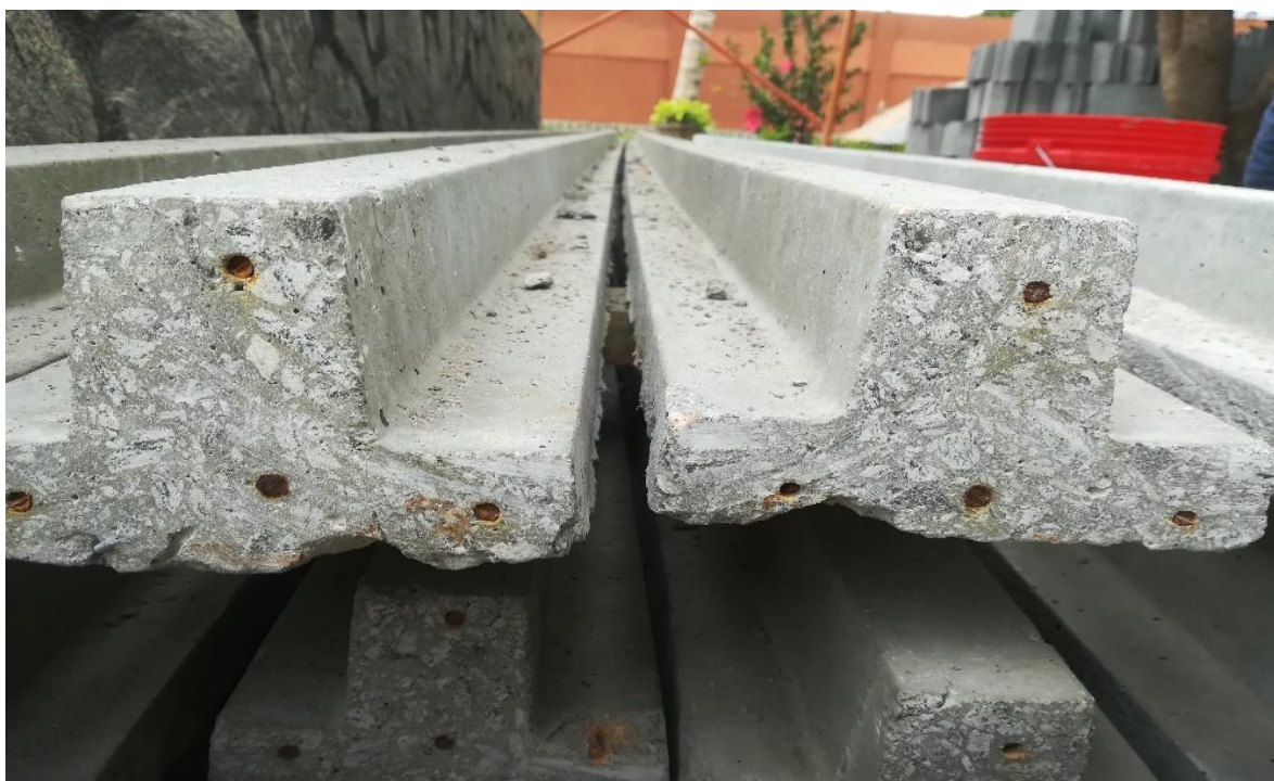
Figura 19: Vigotas de betão pré-esforçado
