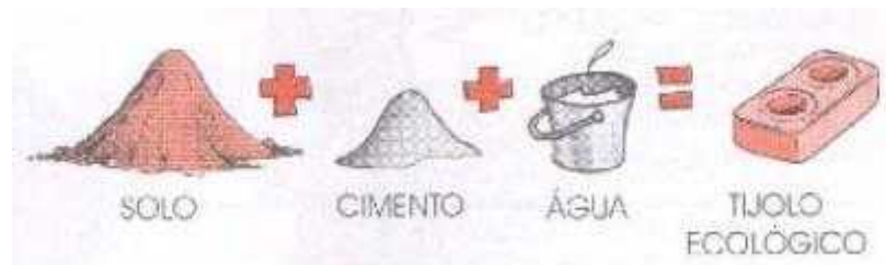
figura 5: Componentes da mistura de solo-cimento
