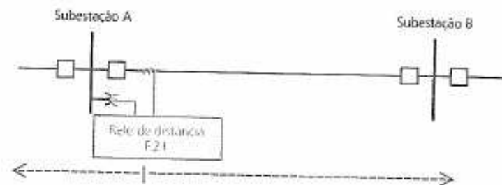
Figura 18.8 – Diagrama representativo de localização do relé F.21.
