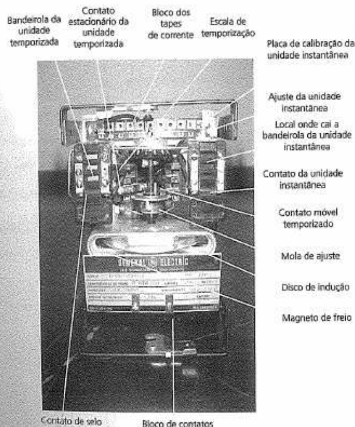
Figura 4.4 Relé de sobrecorrente de disco de indução
