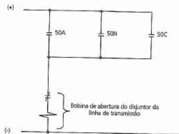
Figura 14.21 – Circuito de abertura do disjuntor da linha de transmissão pela operação dos relés de sobrecorrente.
