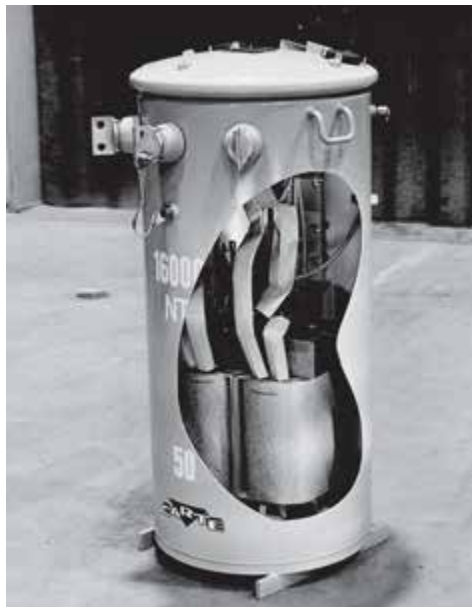
FIGURA 23-3 Transformador de distribuição (visão parcial) do tipo usado por concessionárias elétricas para distribuir energia para os usuários residenciais e comerciais. O tanque é preenchido com óleo para melhorar o isolamento e remover o calor do núcleo e dos enrolamentos. (Cortesia de Carte International Inc.)
