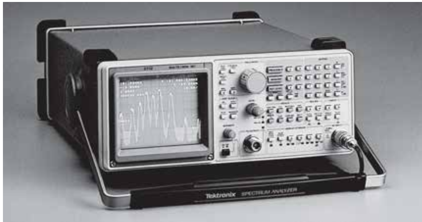
FIGURA 25-31 Analisador de espectro (Cortesia de Tektronix Inc.)
