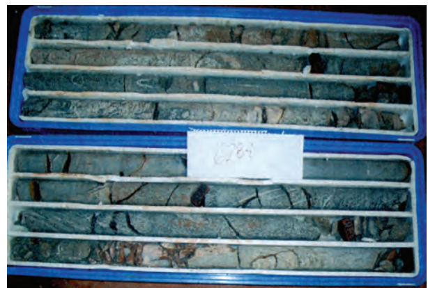
FIG. 7.19 Caixa de testemunhos/amostras de sondagem rotativa. Notar o alto estado de fragmentação
