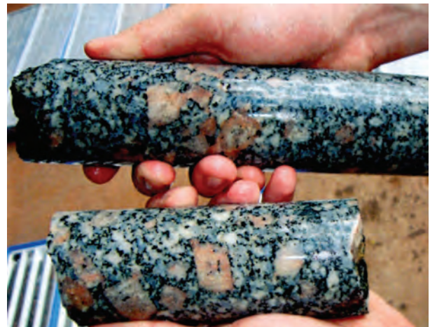
FIG. 7.18 Caixa de testemunhos/amostras de sondagem rotativa. Notar a recuperação total indicando rocha maciça, sem fraturas
