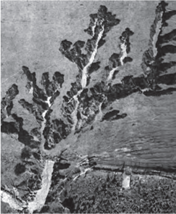
FIG. 12.12 Boçoroca na região noroeste do Estado de São Paulo
