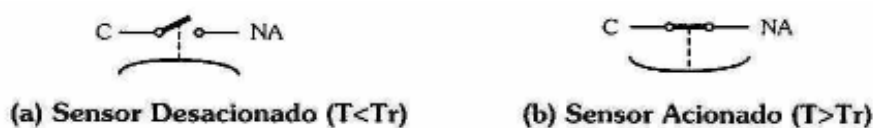
Figura 6.11 - Termostato de Lâmina Bimetálica.
