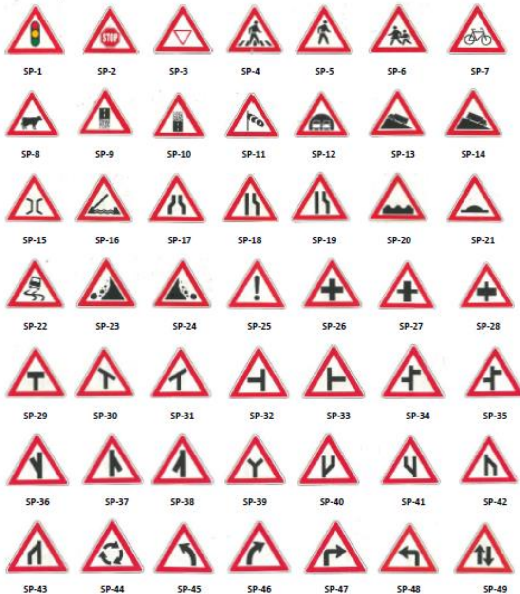
Figura 2. Sinais de perigo
