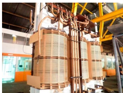
Figura 11: Constituição de bobinas dum transformador trifásico. (Silva Miguel, 2016).
