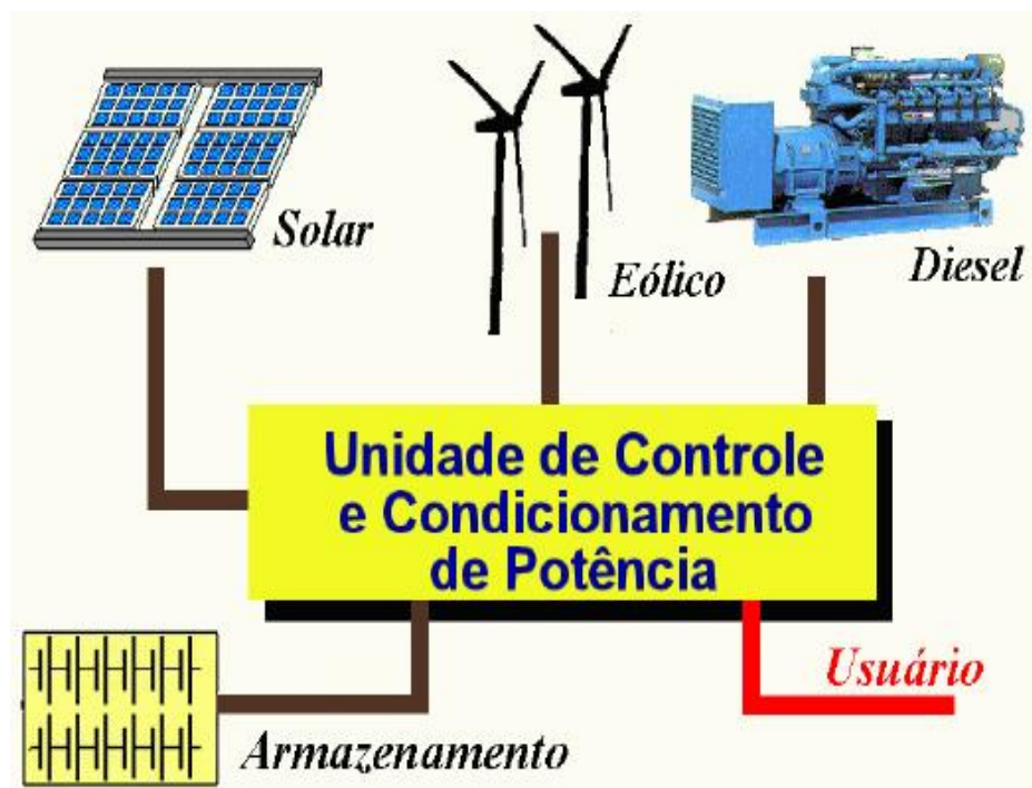
Figura 2: Exemplo de Sistema Híbrido
