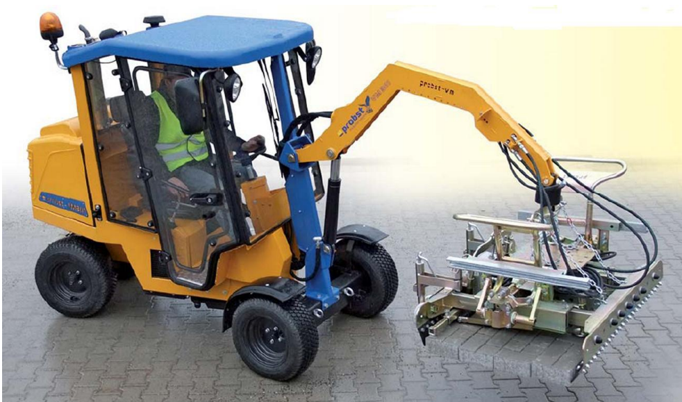
Figura 17- Assentamento mecanizado de Pavês (3).
