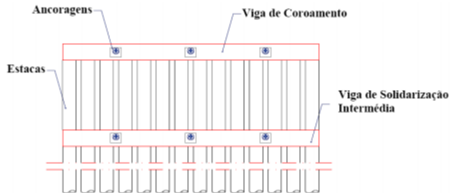
Figura 25- Esquema em alçado de uma cortina de estacas com dois níveis de ancoragens [28].
