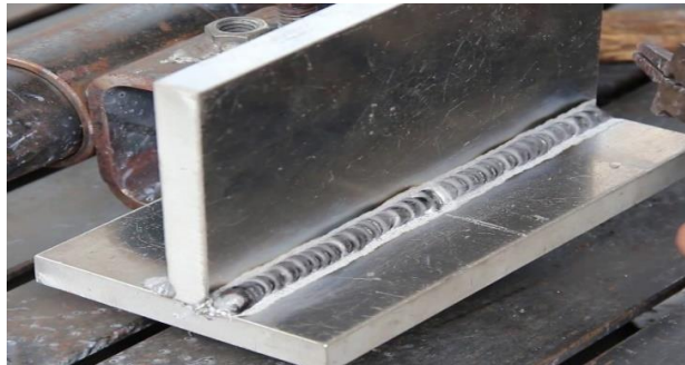
Figura 12. Ligação soldada fita feita com eletrodes
