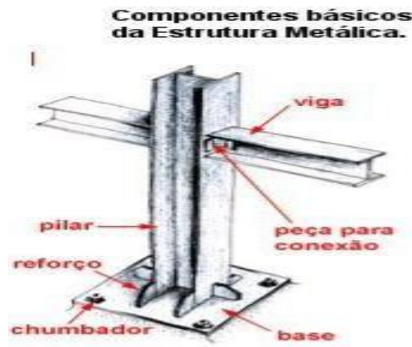
Figura 8. Componentes de uma abrigo metálico. Fonte (Pfeil, 2008)
