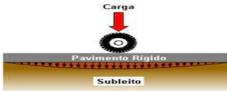
Figura 2.4.2 Distribuição de carga no pavimento rígido.
