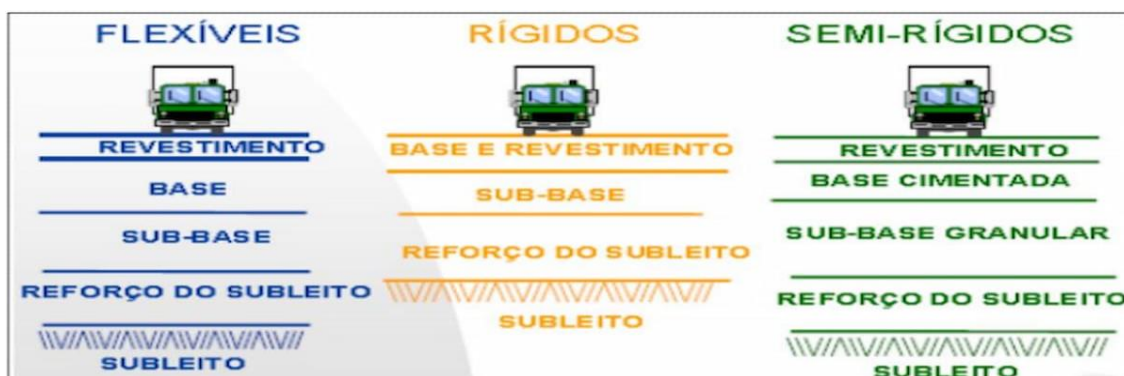
Figura 2.3.1 Camadas dos pavimentos flexível, rígido e semi-rígido
