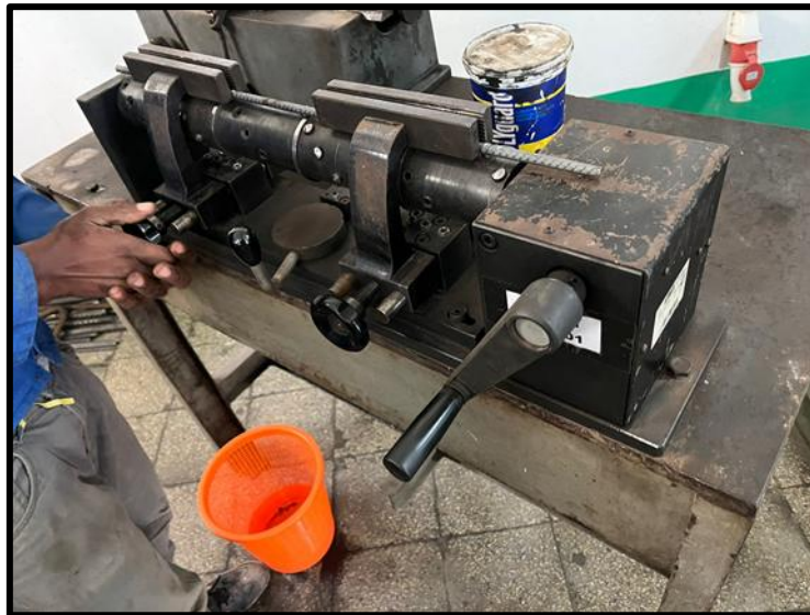
Figura 18: Equipamento de marcação de provetes
