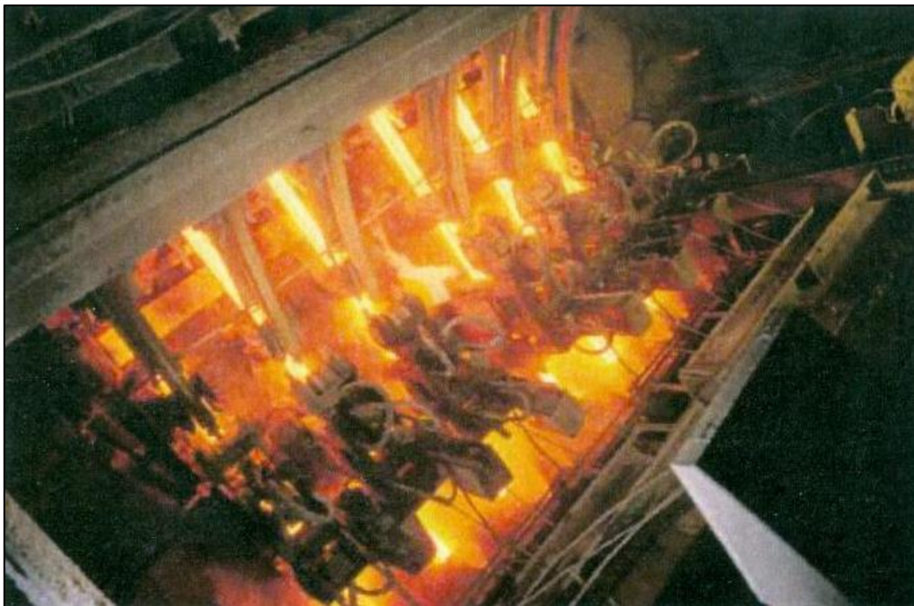
Figura 6: Vazado de forma contínua
