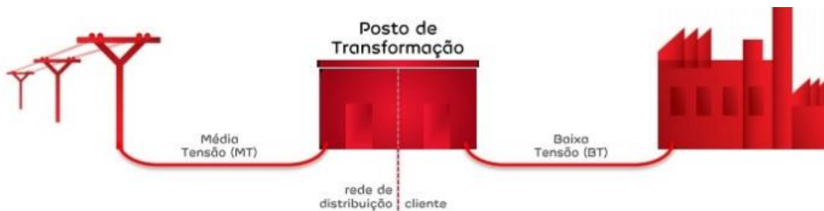
Figura 2. Interligação da rede MT com a rede BT
