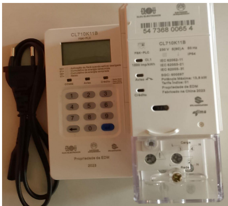
Figura 3. Contador de energia eléctrica para residências
