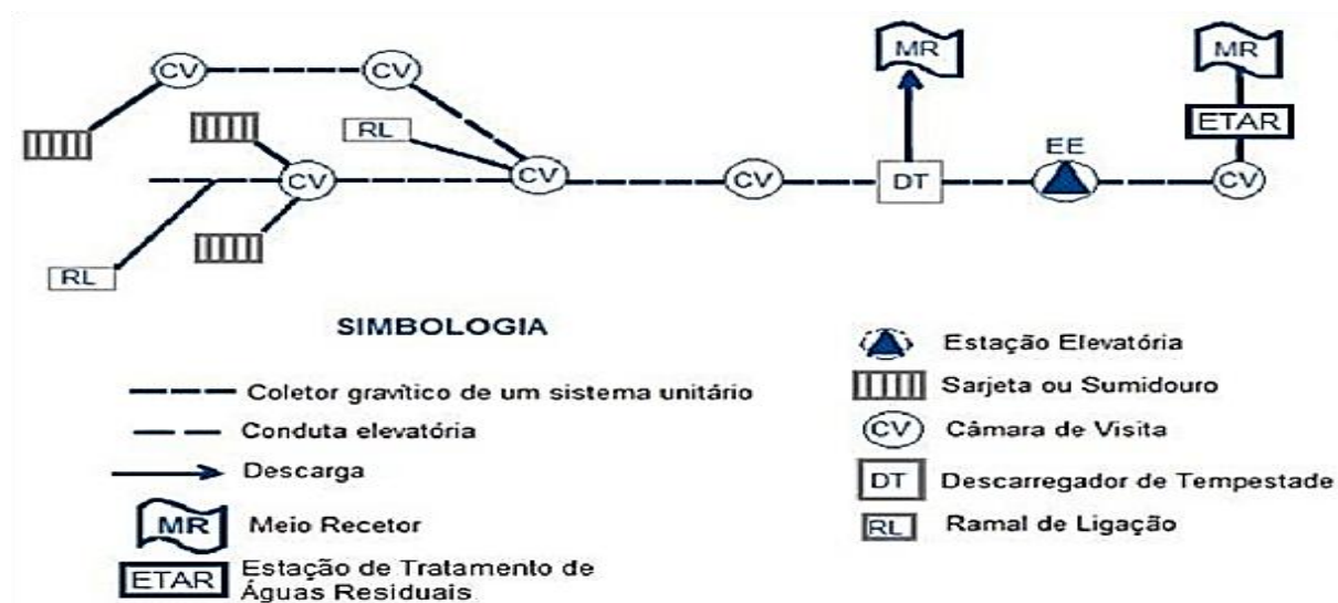
Figura 5. Representação Esquemática do sistema do tipo unitário. [Lourenço, 2014]
