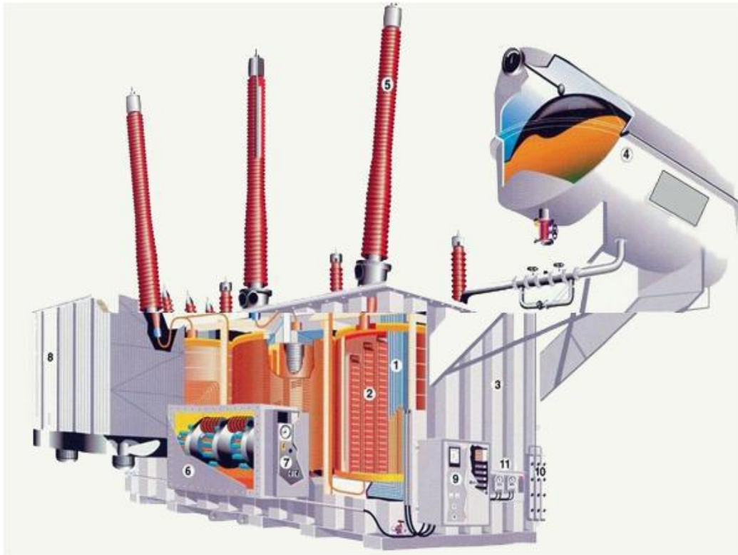
Figura 2: Constituição de um transformador de potência
