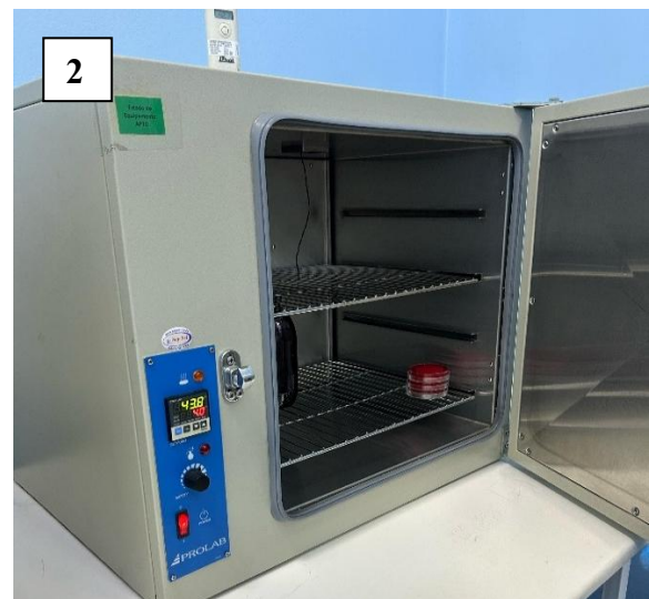
Foto 5: (1) Incubação de coliformes totais a 36° C; (2) Incubação de coliformes fecais a 44° C.
