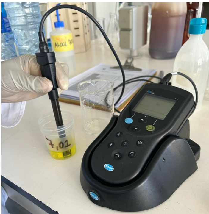
Foto 8: Medição do pH usando o medidor de pH
