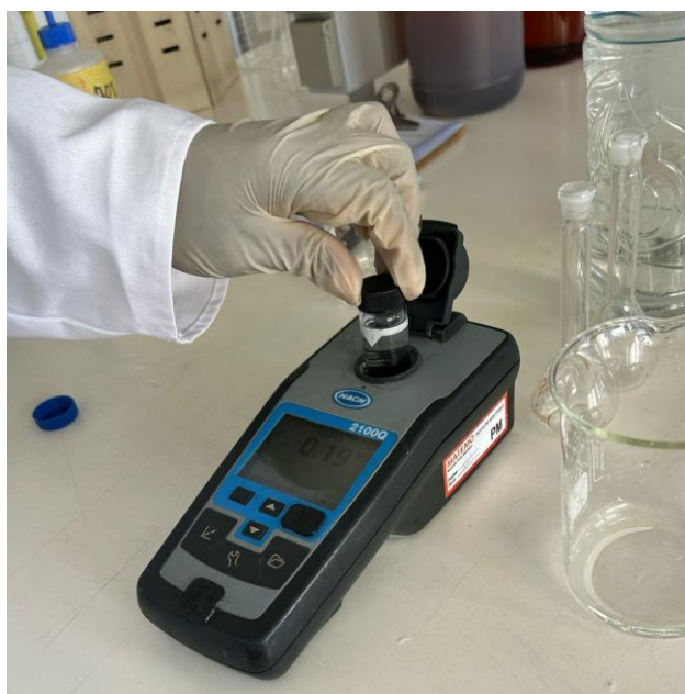
Foto 9: Medição do turbidez usando o turbidímetro
