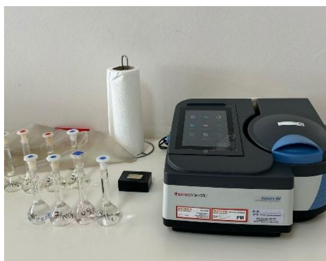
Foto 11: Determinação do amoníaco usando o método de Nessler directo
