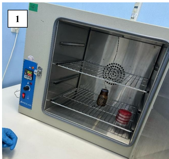
Foto 5: (1) Incubação de coliformes totais a 36° C; (2) Incubação de coliformes fecais a 44° C.
