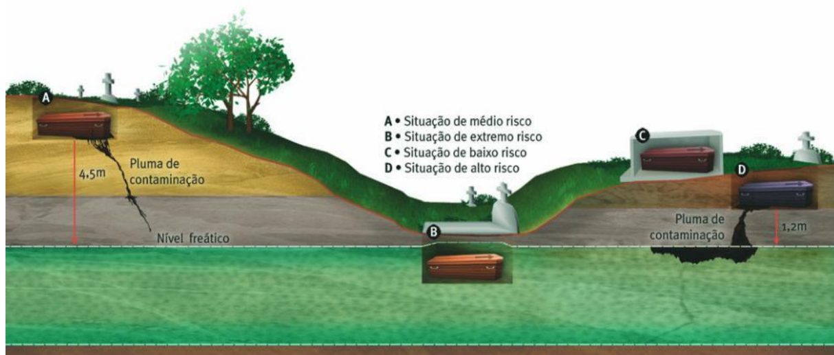
Figura 4: Esquema da contaminação dos lençóis freáticos pelo necrochorume
