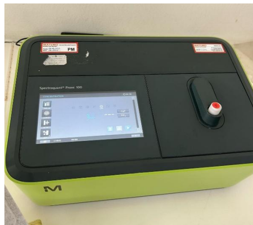
Foto 13: Determinação de nitratos usando o método do ácido fenol-dissulfônico
