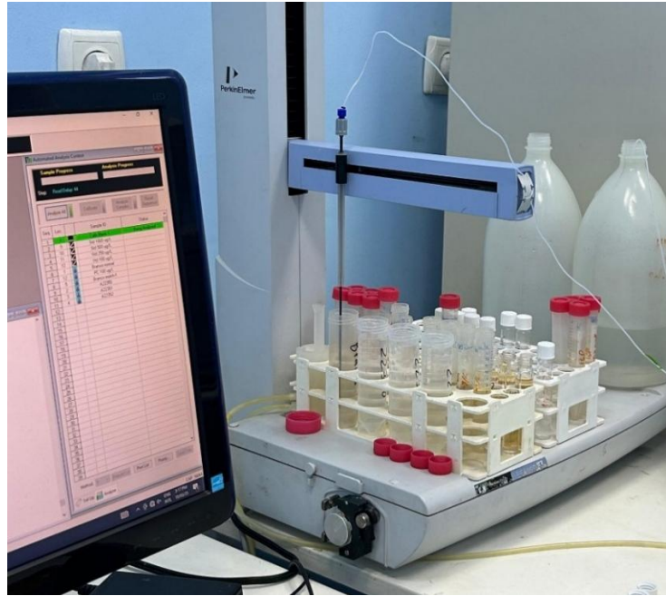
Foto 6: Posicionamento das amostras de água e dos reagentes na máquina de leitura
