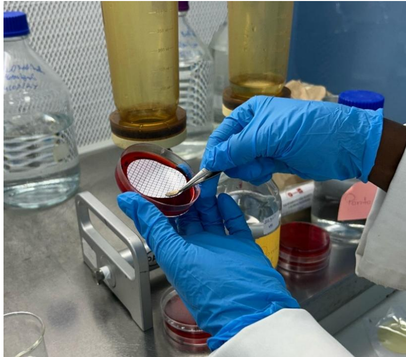
Foto 4: Aplicação da membrana filtrante previamente removida do filtro na incubadora
