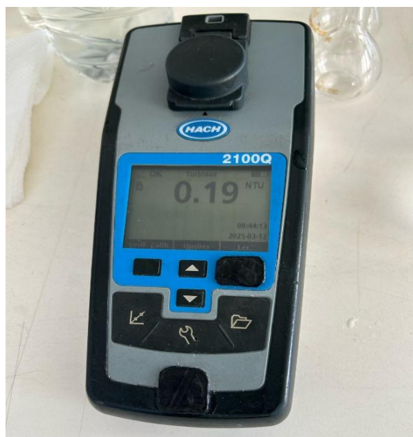
Foto 9: Medição do turbidez usando o turbidímetro
