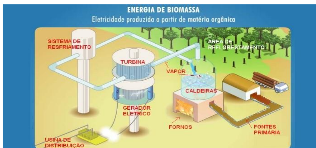
Figura 22: Esquema de Funcionamento de uma Central de Biomassa
