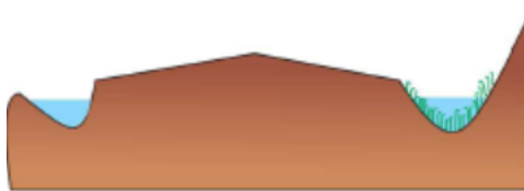
Figura 9 - Drenagem lateral inadequada com nível de severidade alta.
