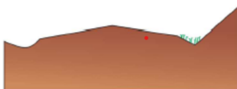
Figura 7 - Drenagem lateral inadequada com nível de severidade baixa.
