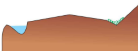
Figura 8 - Drenagem lateral inadequada com nível de severidade média.
