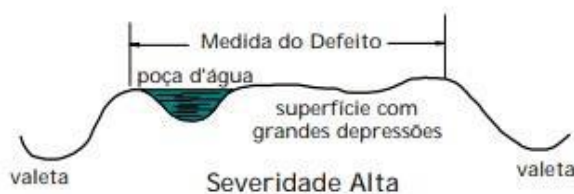
Figura 6 - Exemplo de Seção Transversal com severidade alta
