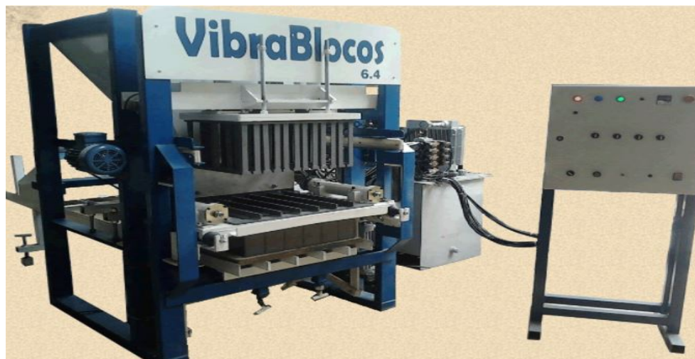
Figura 14: Máquinas de fabrico de blocos de betão estrutural.
