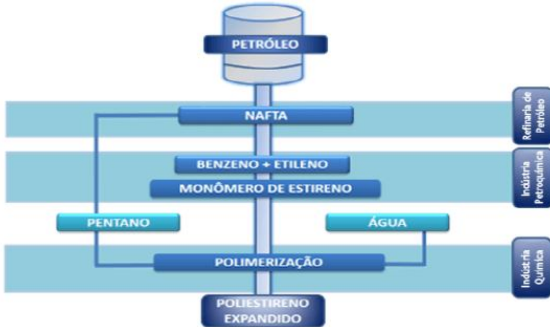
Figura 27: Processo de produção de EPS.
